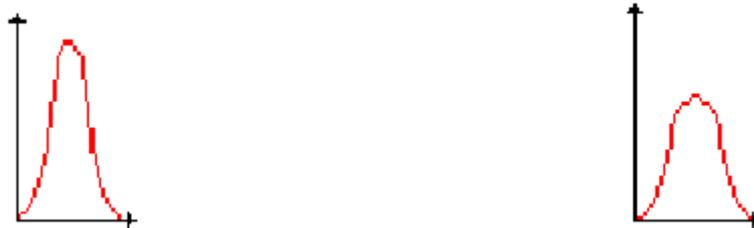
Figure 2.6: L'effet de la dispersion et de l'atténuation dans la fibre optique
